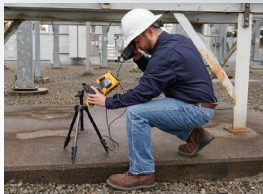
Обследование оборудования с безопасного расстояния при помощи штатива с держателем и видеоскалера
