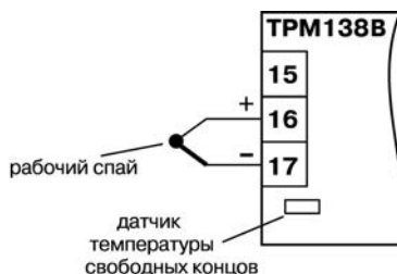
Рисунок 3.3 – Схема подключения ТП
