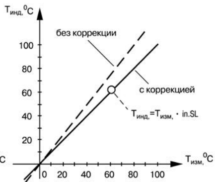
Рисунок 3.7 – Коррекция «Наклон характеристики»
