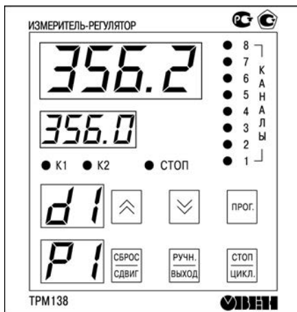
Рисунок 3.18 – Лицевая панель прибора
