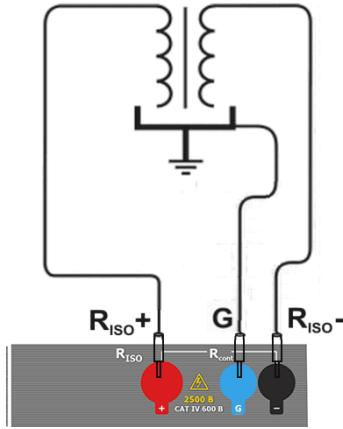
При измерении сопротивления между жилой кабеля и экраном, влияние поверхностных токов (особое влияние оказывают при сложных погодных условиях) устраниют соединением кусочка металлической фольги, навитого на изоляцию измеряемой жилы, с разъёмом **G**.
