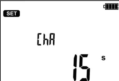
Следующее нажатие **→** вызывает переход к установке интервала времени **ChA** для снятия характеристики  $R_{ISO}$ .
